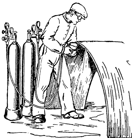
Рис. 24. Резка металла автогеном.
